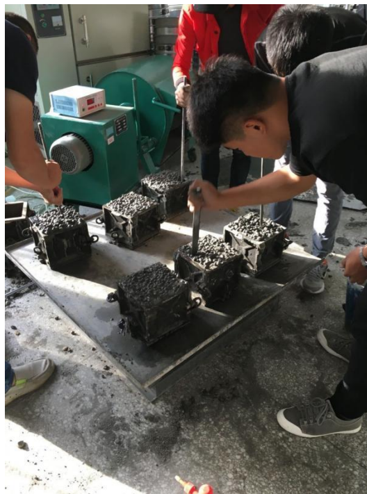
图 14 学生分组完成混凝土的和易性及抗压强度检测
